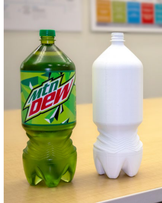
Tam renkli 3D baskı prototip ve düşük kaliteli 3D baskı prototip karşılaştırması
